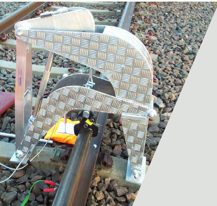
Réduire le risque de déraillement dû aux déformations ou aux ruptures des rails est depuis longtemps une priorité des compagnies ferroviaires et des ingénieurs de la voie. Pour ce faire, mesurer la température sans contrainte des longs rails soudés est essentiel, car cela permet d'identifier et de gérer les faiblesses et les risques. Auparavant, il s'agissait d'une opération longue, coûteuse et souvent peu fiable qui impliquait de couper le rail.
