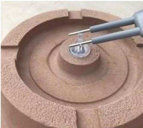
Placer les électrodes de la poignée d'allumage sur les bornes de démarreur STARTWEL®.
