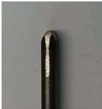
Les burins sont fournis d'origine avec un rayon adéquat. Ils doivent cependant être régulièrement contrôlés par l'opérateur au fur et à mesure de leur utilisation. Plus la température de martelage est élevée (300°C maximum), plus l'usure des burins est rapide.
