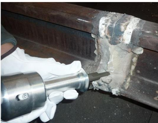
**Figure 8: Nettoyage : enlèvement des bavures métalliques**
