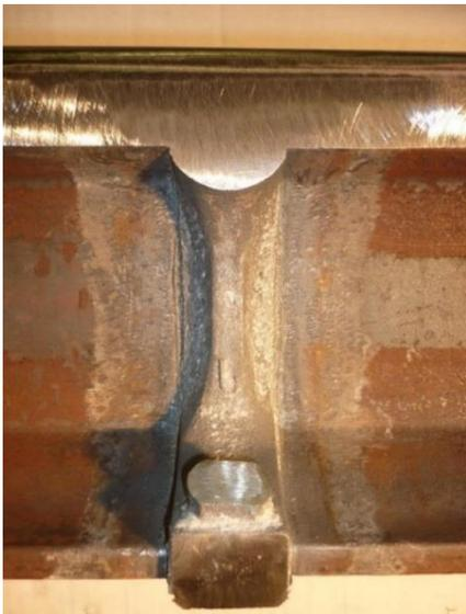
**Figure 7: Nettoyage à chaud : enlèvement du sable**
