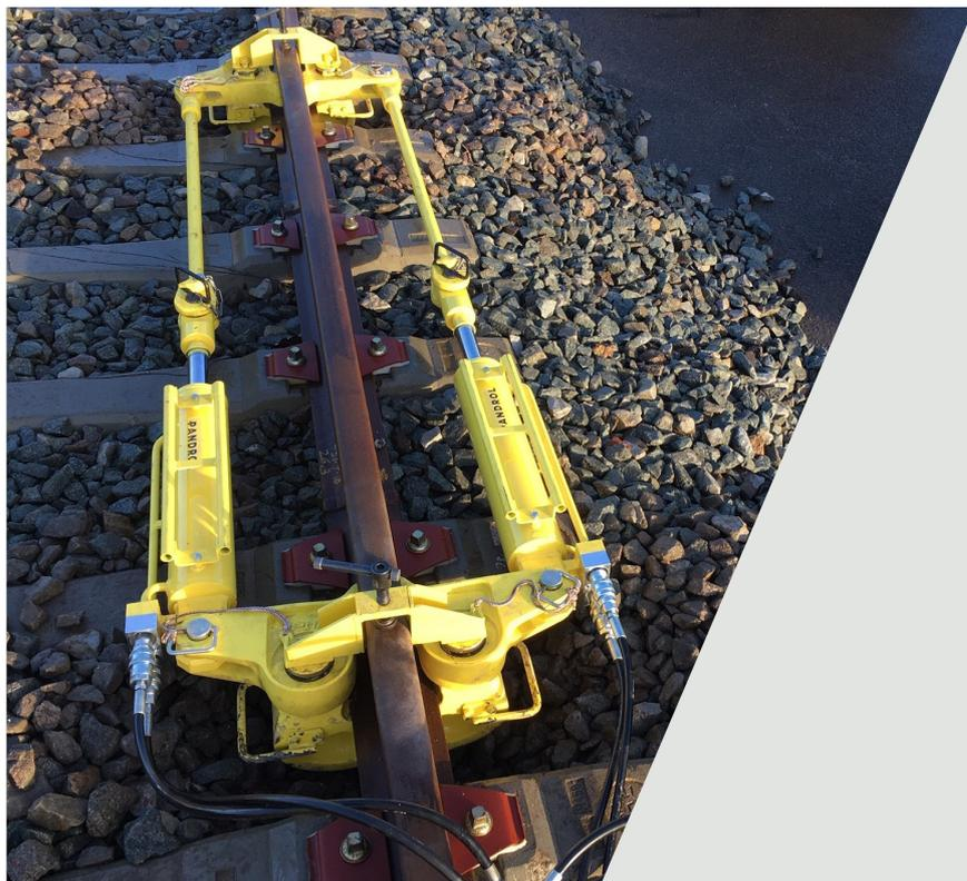
A Tensora de trilhos TR75 foi concebida para o alívio de tensões ou para a substituição de trilhos soldados contínuos (CWRs). É usada em trabalhos de manutenção para esticar longos trilhos soldados antes da soldagem aluminotérmica e para fixar o trilho tensionado durante o corte. É capaz de unir e manter uma distância constante entre as duas extremidades do trilho.
