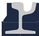
FTrack Pandrol en 4 parties avec profils en caoutchouc pleins.
