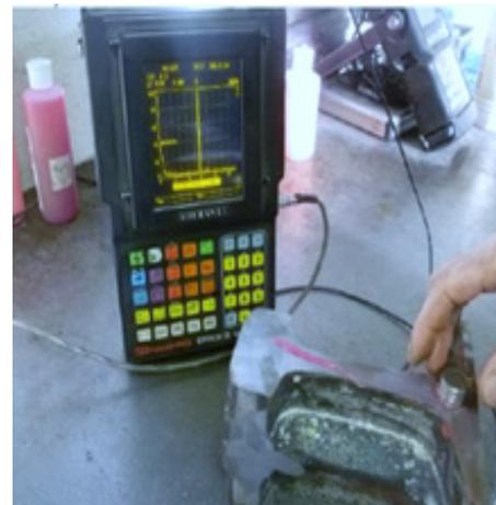
Contrôle Non destructifs : Ressuage, Magnétoscopie, Tests ultrasons (phase d'Array)
