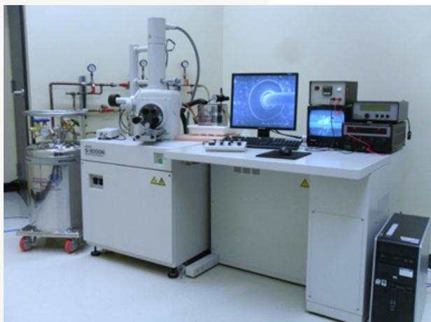
Microscope Electronique à Balayage avec sonde EDS
