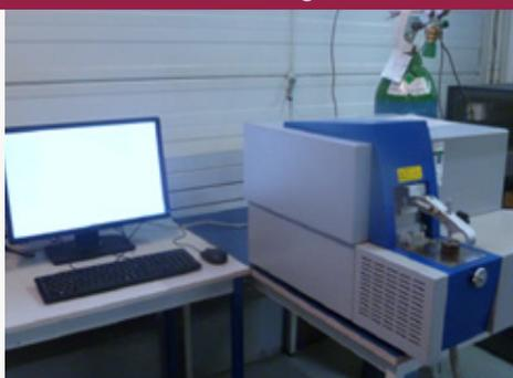
Analyses chimiques avec spectromètre
