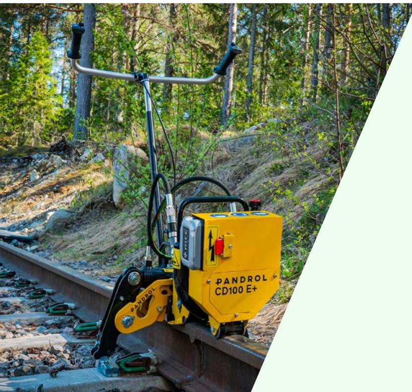
La clippeuse CD100 B a été conçue pour les opérations d'insertion et d'extraction des clips Pandrol. Compacte et légère, elle peut être facilement transportée sur le site par une seule personne.
