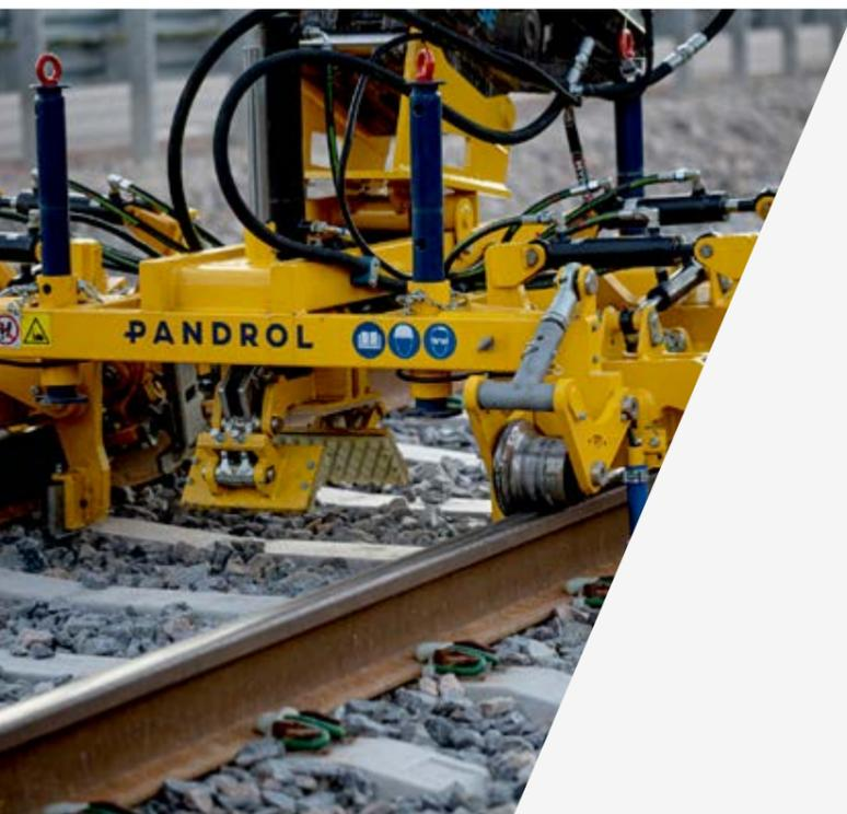
La clippeuse CD300 IQ permet l'installation à haut rendement des Fasclip FC et FE Pandrol. La clippeuse CD300 IQ EC est une version spécialement conçue pour le système de fixation e-Clip.
