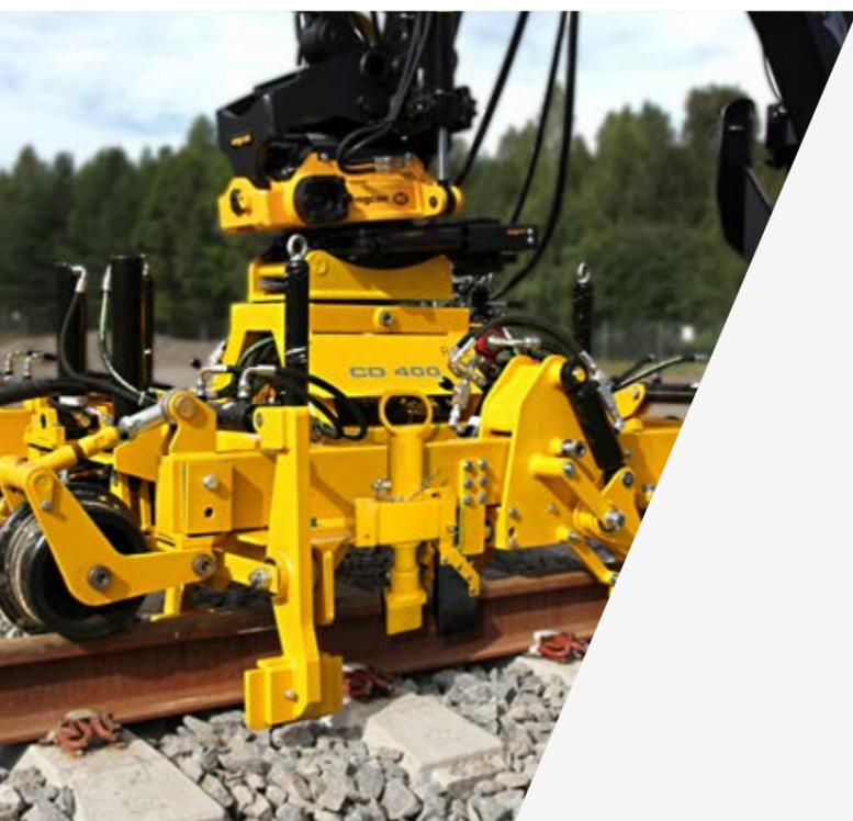
Robuste et hautement performante, la clippeuse CD400 permet d'insérer et d'extraire les clips FC, FE et e-Clips Pandrol. Quand elle est équipée de capteurs de proximité, la CD400 fixe automatiquement les clips, offrant un niveau élevé de sécurité et de productivité.
