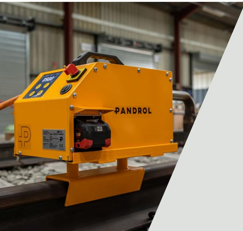
Le préchauffeur à haut débit Pandrol 36V (HFP 36V) est un système de préchauffage universel pour la soudure aluminothermique. Il a été conçu pour remplacer l'ensemble des équipements utilisés actuellement et simplifier le travail du soudeur.
