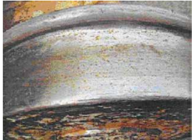
Fig 125. Limite de fissuration circonférentielle associée au retournement
