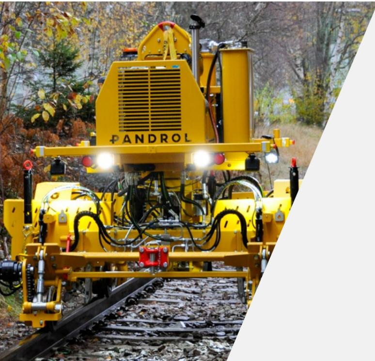
A CD400SP IQ é a nossa instaladora de grampos autopropulsada de segunda geração, lançada após a CD400SP original.
