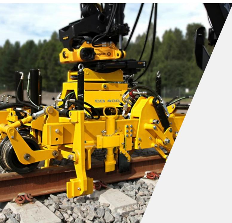
Robusta e de alto desempenho, a instaladora de grampos CD400 é capaz de instalar e extrair grampos FC, FE e e-Clips Pandrol. Quando equipada com sensores de proximidade a CD400 fixa automaticamente os grampos, proporcionando altos níveis de segurança e produtividade.
