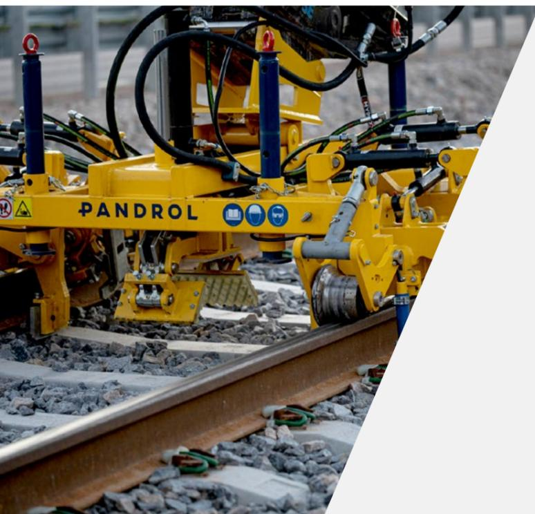
A instaladora de grampos CD300 IQ permite alta eficiência na aplicação de Fastclip Pandrol FC e FE. A instaladora de grampos CD300 IQ EC é uma versão especialmente projetada para o sistema de fixação e-Clip.
