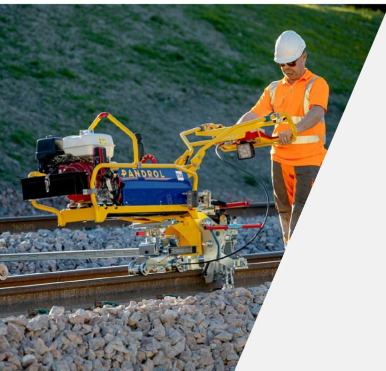
A instaladora de grampos inteligente CD200 IQ é a primeira máquina da nova linha IQ da Pandrol. Ela usa um sistema de controle inteligente para simplificar a operação. Este novo sistema fornece informações sobre os grampos colocados e a quantidade de horas de operação, evitando assim o uso indevido da máquina.
