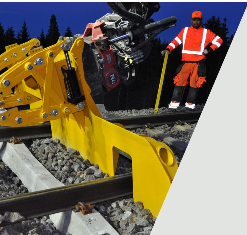
As máquinas de substituição de dormentes SB40 e SB60 são acessórios concebidos para substituir os dormentes com segurança e eficiência.
