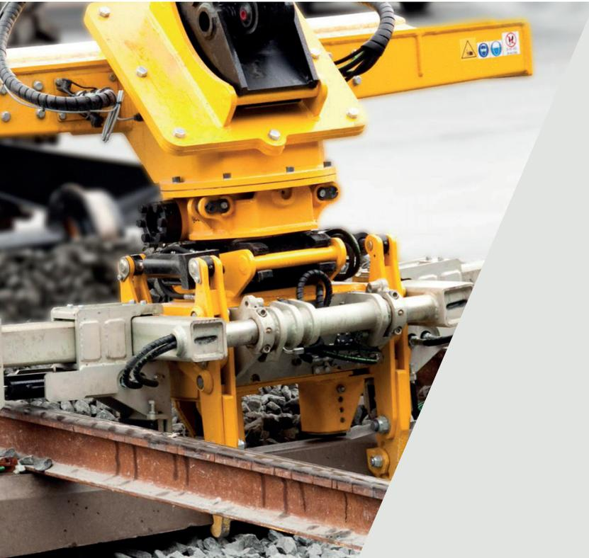
El Auto Master de Rosenqvist Rail se ha desarrollado para su uso al instalar productos Pandrol FC y FE Fastclip como parte de las operaciones de cambio de traviesas. Se trata de un accesorio montado en un soporte y está disponible como accesorio para los cambiadores de traviesas SB40 y SB60.
