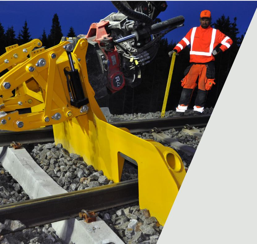
Les machines à remplacer les traverses SB40 et SB60 sont conçues pour remplacer les traverses de manière sûre et efficace.
