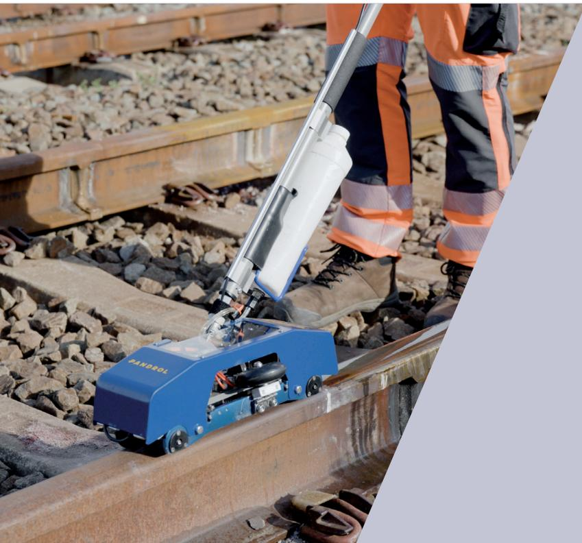
Caractéristiques, métriques analysées, SonicVizio-WS-S est un système léger utilisé pour la détection de défauts ferroviaires sur tout type de voie.
