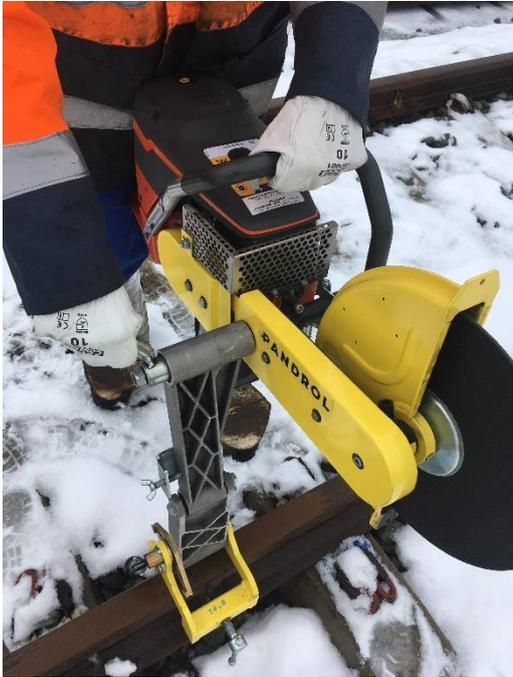
Le manchon à double entrée permet de positionner la tronçonneuse, soit à l'intérieur, soit à l'extérieur de la voie.
