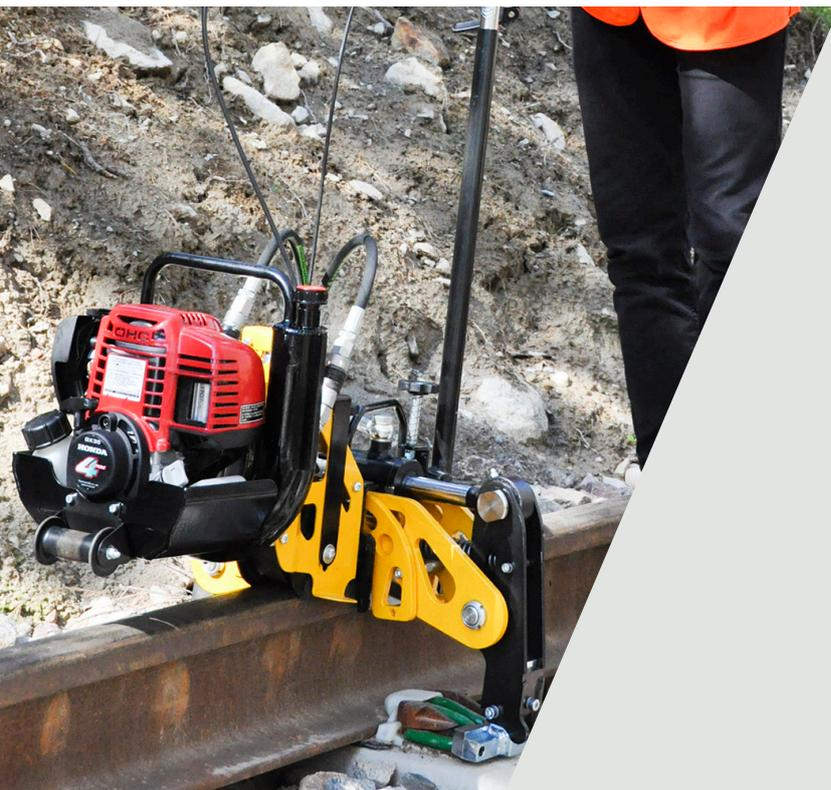
La clippeuse CD100 sur a été conçue pour les opérations d'insertion et d'extraction des clips Pandrol. Compacte et légère, elle peut être facilement transportée sur le site par une seule personne.
