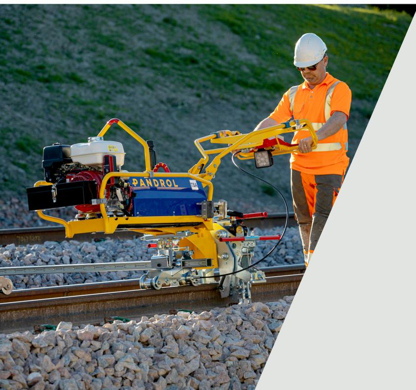
La clippeuse CD200 IQ utilise des systèmes de contrôle intelligents pour simplifier l'utilisation. Le nouveau système intelligent peut fournir des informations sur les clips installés et le nombre d'heures de fonctionnement, tout en empêchant une utilisation incorrecte de la machine.
