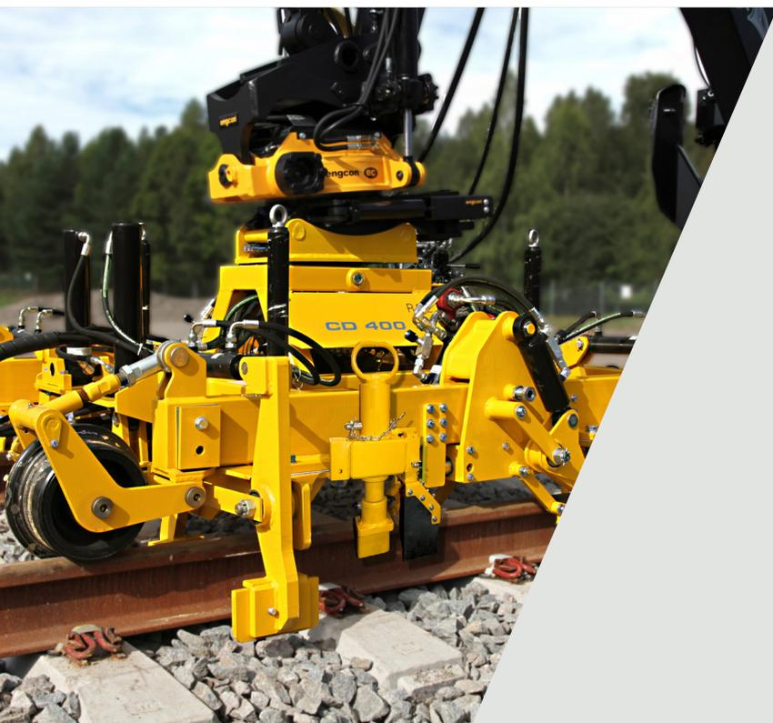
La clippeuse CD400 de Rosenqvist Rail est une machine de clippage robuste et performante qui clippe et déclipse les Fastclips et e-Clips de Pandrol. Quand elle est équipée de capteurs de proximité, la CD400 fixe automatiquement les clips, offrant un niveau élevé de sécurité et de productivité.
