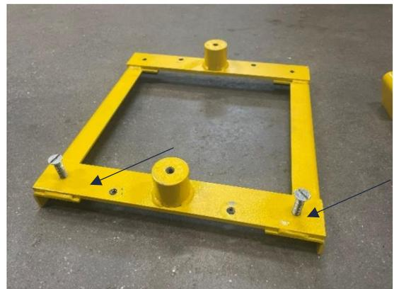
Support avec vis de maintien en position rangées
