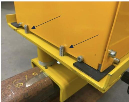
Support avec vis de maintien en position
