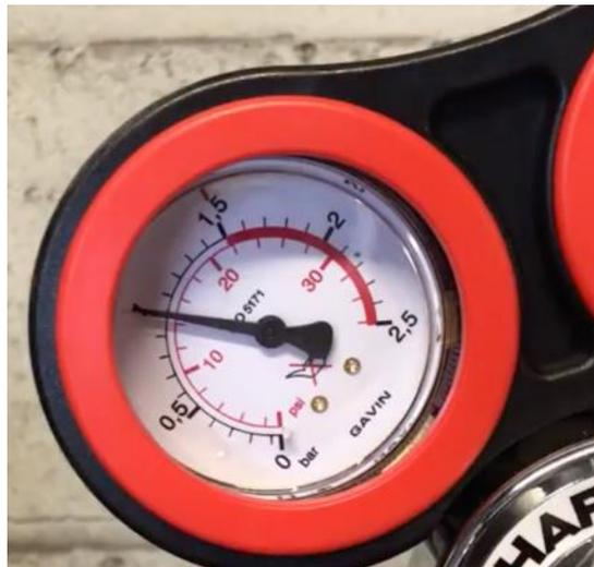
Le réglage de la pression de gaz s'effectue en tournant doucement la molette de couleur noire du détendeur HARRIS
